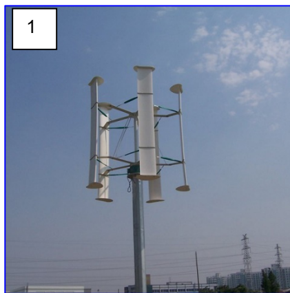
Fig. 8.2.c – Principalele tipuri de turbine eoliene 1 – cu ax vertical; 2 – cu ax orizontal
